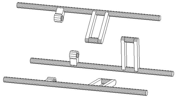
**Fig. 8-Short Rocker-Arm, Rocker-Shaft and Long Rocker-Arm**
